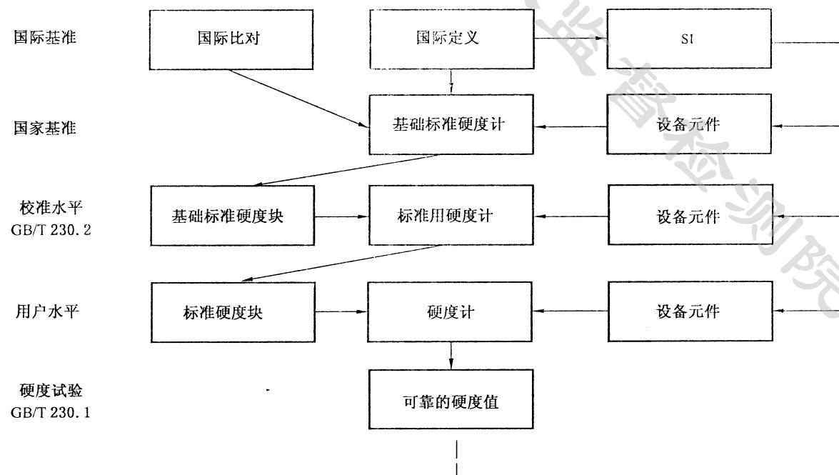
注:图 G.1 的左侧表示通过校准层级(即国家,校准和用户)中每个级别的单个校准链进行的溯源性路径,包括标准块的校准和洛氏硬度试验机的间接检定。基础标准硬度计(国家级)用于校准基础标准硬度块,基础标准硬度块用于校准校准用硬度计(校准级),校准用硬度计用于校准标准硬度块,标准硬度块用于校准硬度计(用户级)。
