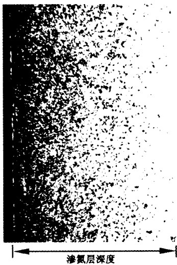
图 3 40Cr 钢离子渗氮 (硒酸+盐酸+乙醇溶液侵蚀) ×100
